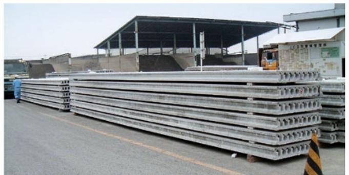
スパンクリート標準製品。スパンクリートは縦方向に数個の穴をもち、PC鋼線によってプレストレスを与えられたコンクリート板です。床材として、また壁材として建築から土木まで多目的に使用可能な材料です。厚さ7cmから35cmまで17種類。高耐力、ロングスパンが特長です。当社はスパンクリートの生産・販売を行っております。
