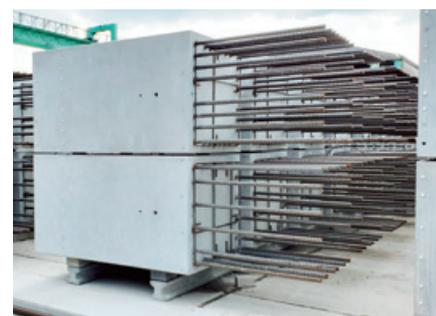
岩瀬工場におけるPCaへの取り組みでは、昨年度出荷した大梁や免震蓋などに加え、大型の柱、化粧柱、手すり壁へのタイル打ち込み、工場塗装を施したバルコニーなど、プレキャスト製品のバリエーションが増えました。今後は更に大型製品製造への取り組みを計画しております。
